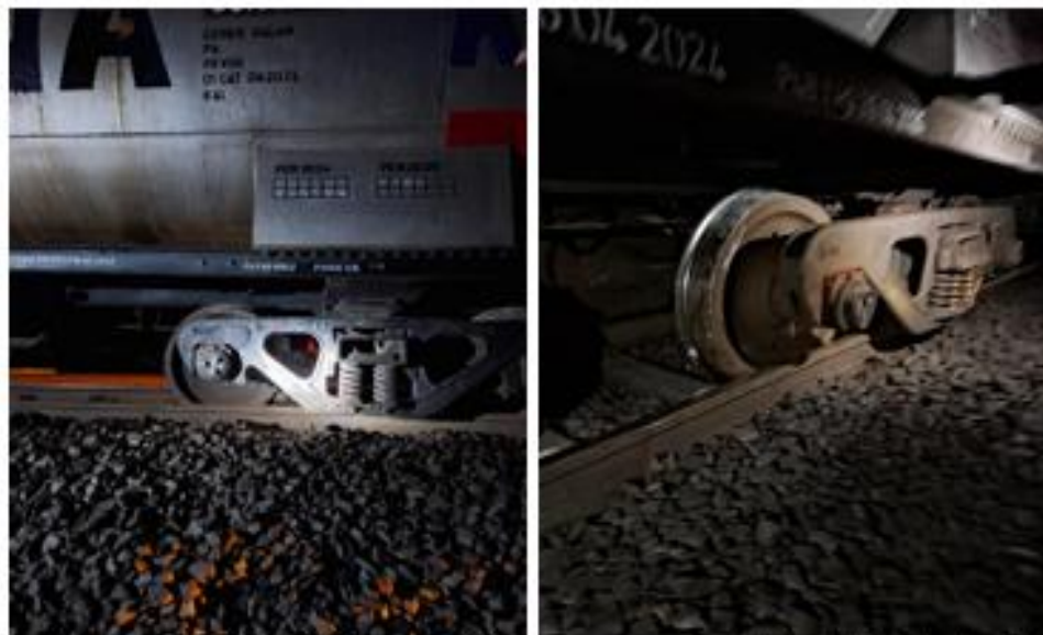
Kondisi rangkaian KA 3992 (Linggapati) yang mengalami anjlokkan di jalur hulu petak jalan Mrl - ME.
